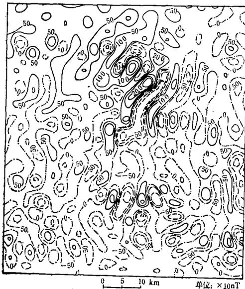
图4 F测区向下延拓500m  $Z_0$ 磁异常平面图
