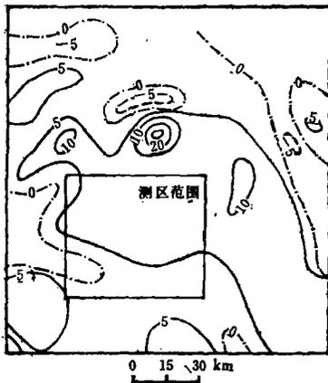
图1 F测区航磁 $\Delta T$ 异常与测区布置图
